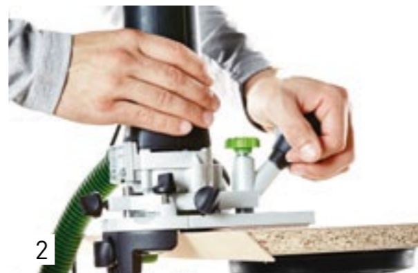
2 Затем выполните фрезерование заготовки заподлицо.
