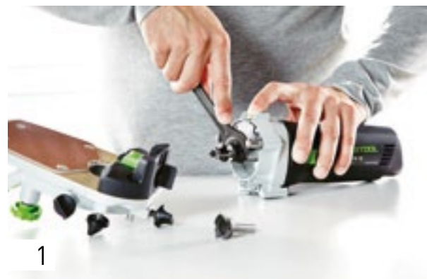
1 Сначала установите на МФК 700 Basic торцевую фрезу.
