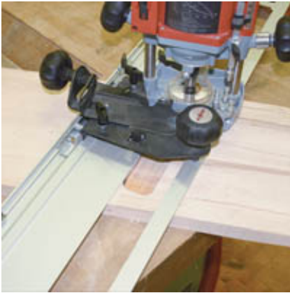
Фрезерное устройство для пазов 640 x 60 мм.
